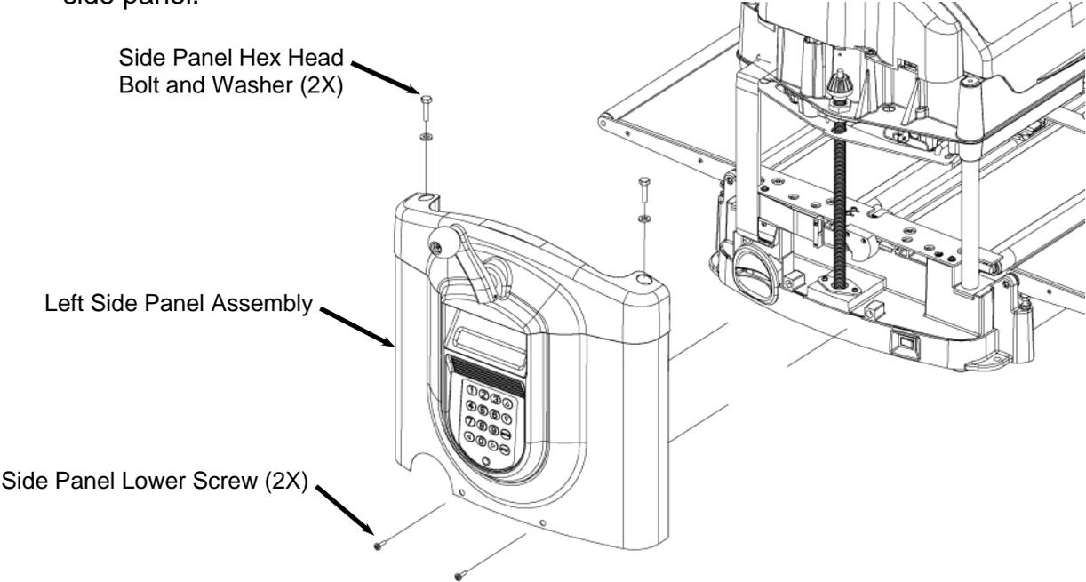
**FIGURE 10:** EXPLODED VIEW OF THE LEFT SIDE PANEL FASTENERS
