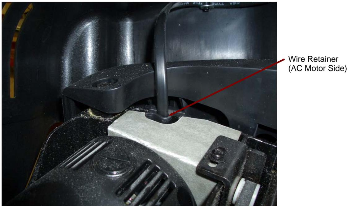
**PICTURE 2:** LOCATION OF AC INTERRUPT SWITCH CABLE WIRE RETAINER
