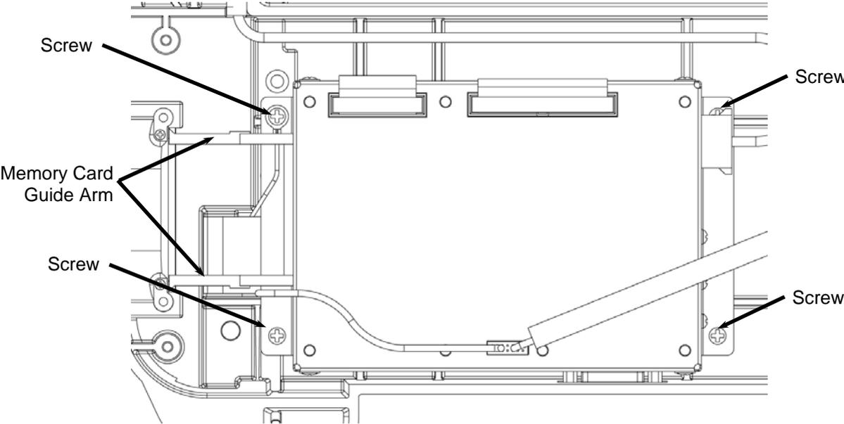
**FIGURE 16:** CONTROLLER BOX ATTACHMENT
