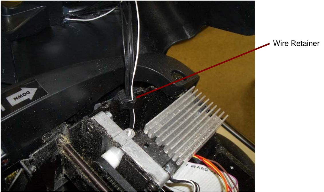
**FIGURE 3:** LOCATION OF HEAD CABLE HARNESS WIRE RETAINER
