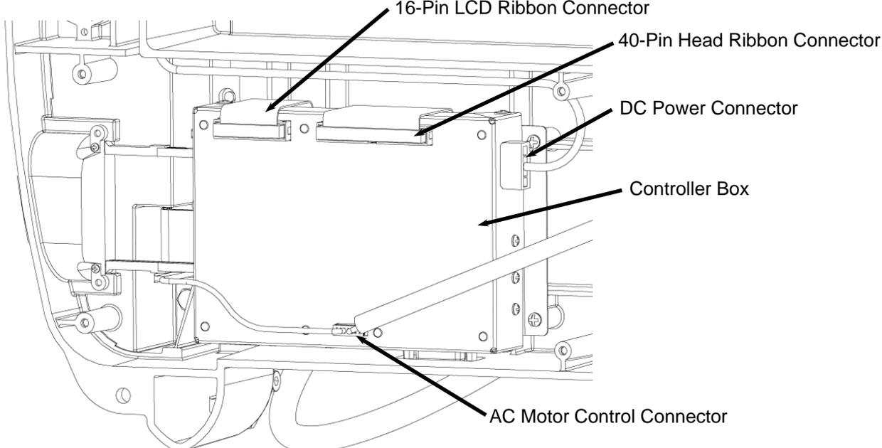
FIGURE 14: LOCATION OF THE CONTROLLER CONNECTORS
