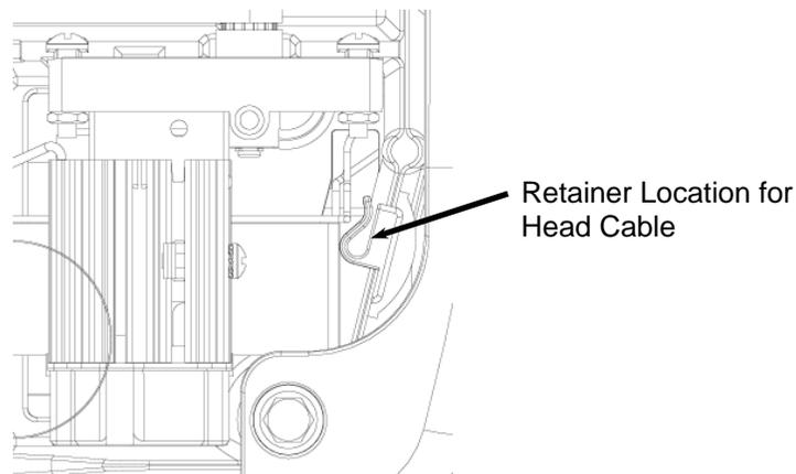
**FIGURE 24:** LOCATING THE HEAD CABLE HARNESS RETAINER
