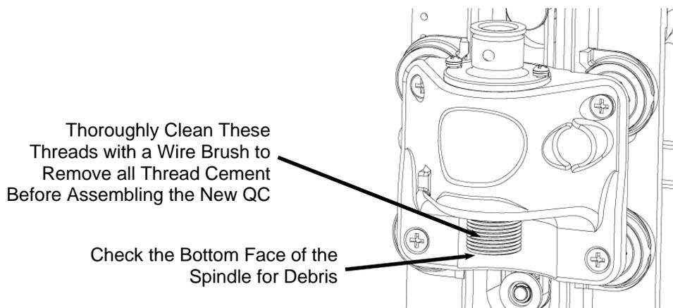
**FIGURE 4:** CLEAN SPINDLE THREADS
