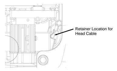
FIGURE 12: LOCATING THE HEAD CABLE HARNESS RETAINER
