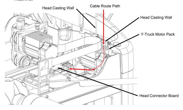
FIGURE 10: ROUTING THE HEAD CABLE HARNESS
